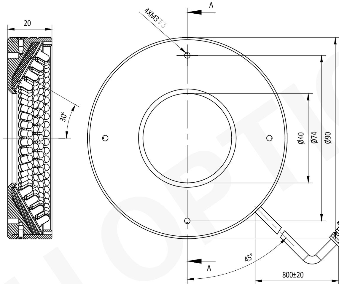
JST 3PIN连接器最小弯曲半径: 20mm
