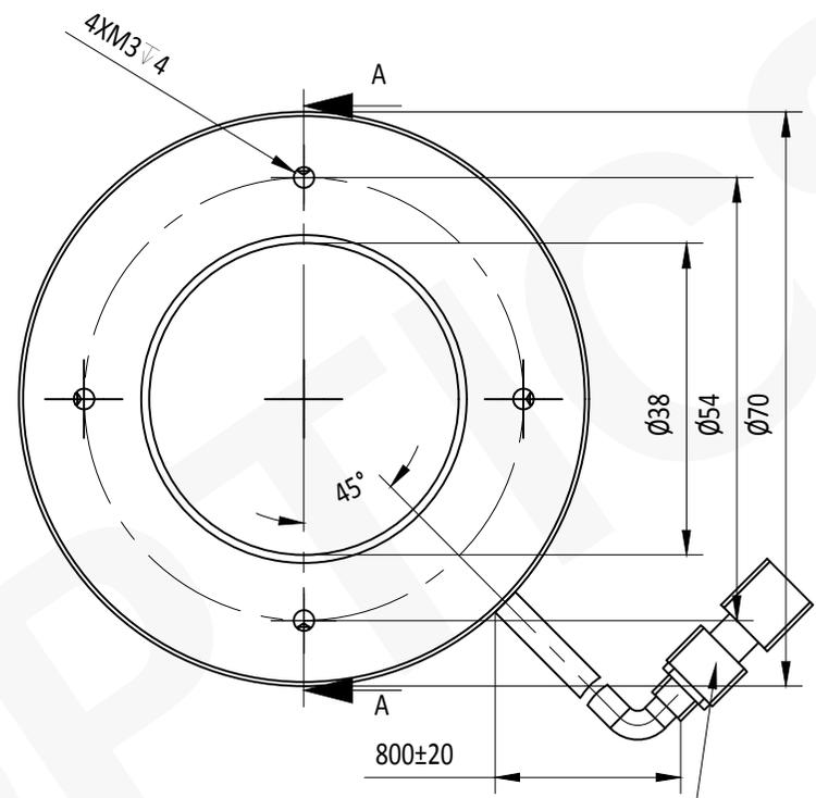
JST 3PIN连接器最小弯曲半径: 20mm
