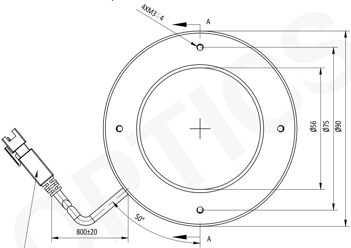
JST 3PIN连接器最小弯曲半径: 20mm
