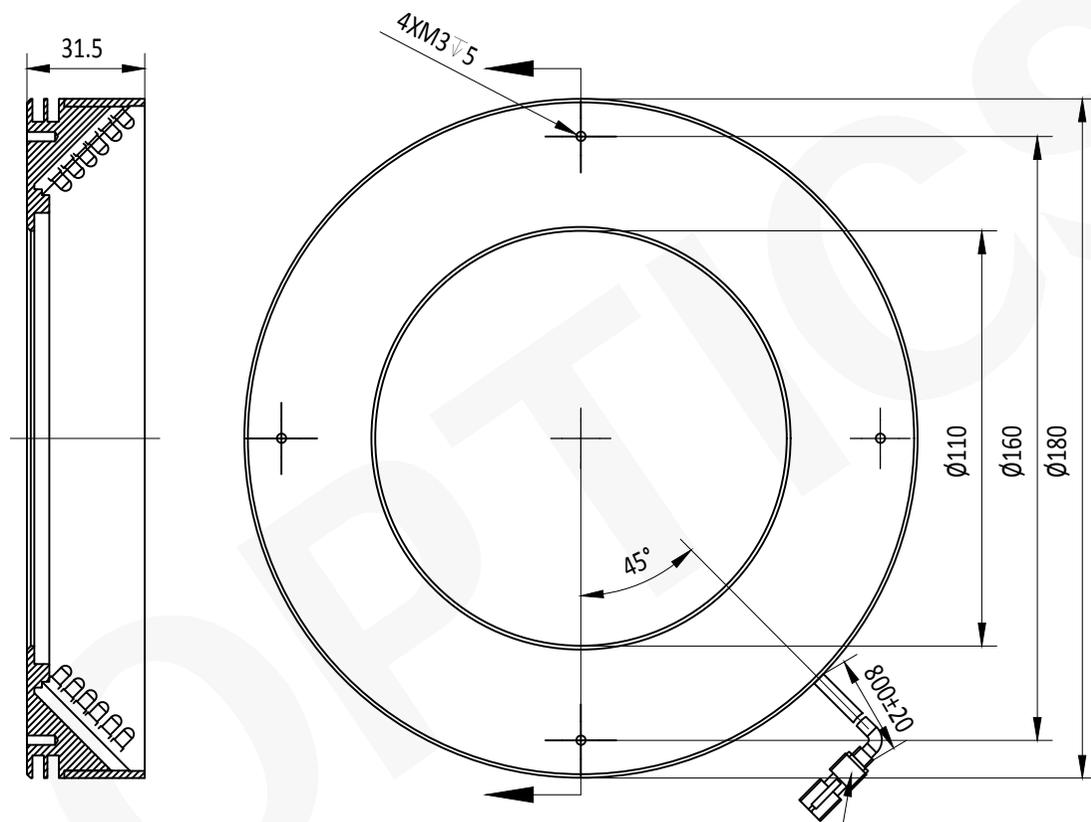
JST 3PIN连接器最小弯曲半径: 20mm
