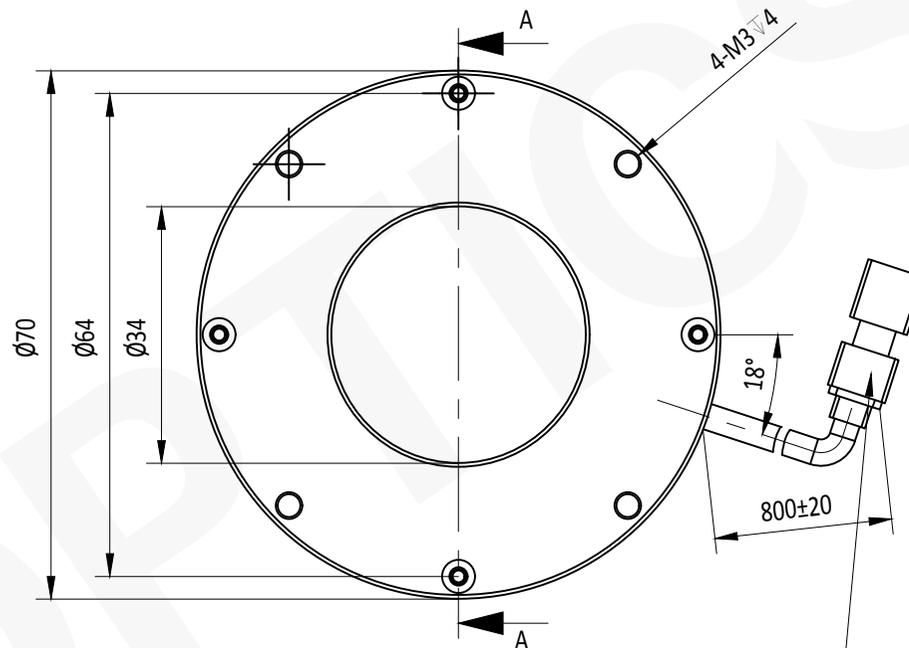
JST 3PIN连接器最小弯曲半径: 20mm
