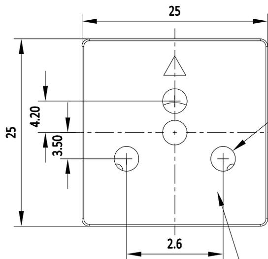
M4螺纹安装孔
